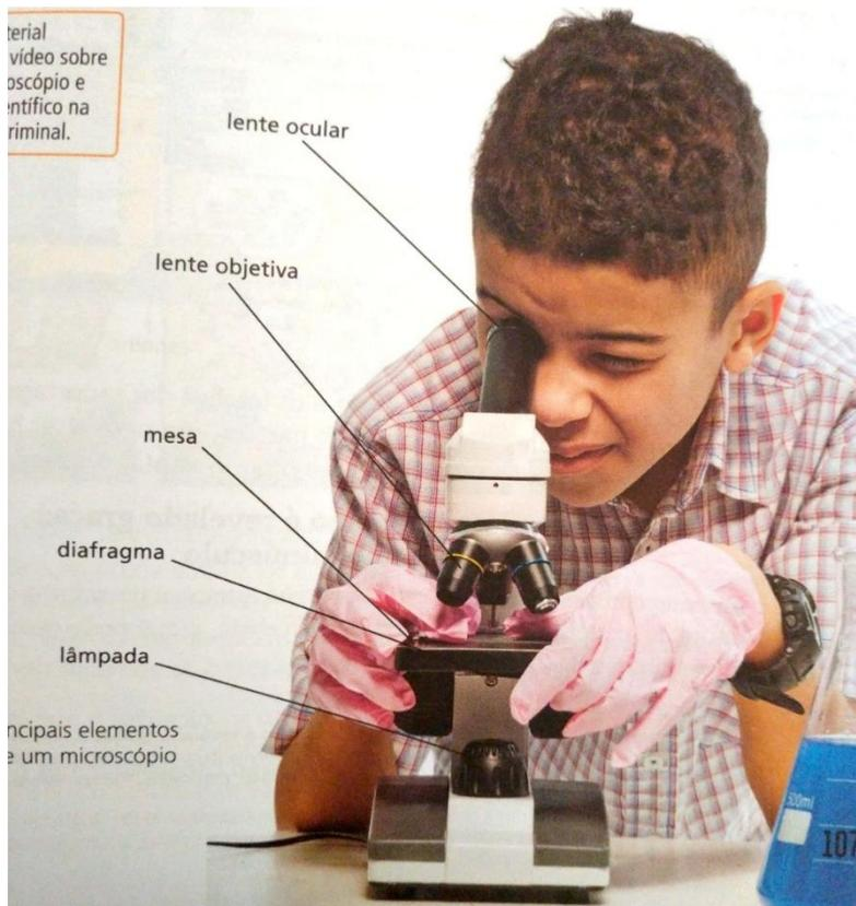
Veja a estrutura básica de um microscópio óptico:
