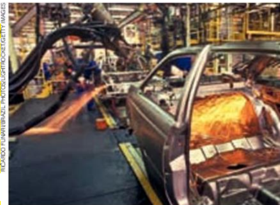
Robôs soldando peças em um chassi de automóvel. São Bernardo do Campo, SP (2016).
