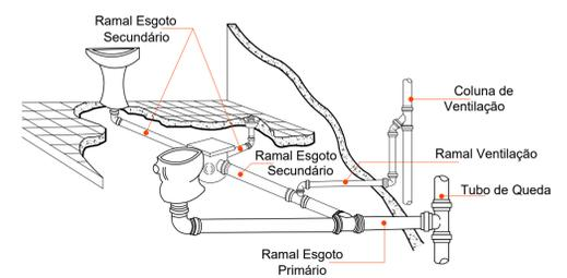
**DETALHE COLUNA DE VENTILAÇÃO**
