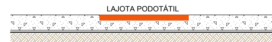
DETALHE CALÇADA DE ACESSO ESCALA 1:10
